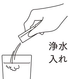
浄水状態の確認のために、蛇口から注いだ水にDPD試薬を入れ、残留塩素濃度の確認をしてください。
