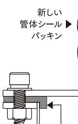
新しい管体シールパッキンは必ず段のある面を下にして取り付けてください。
